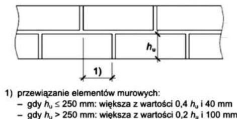
Rys. 5 Wymogi dla wiązania elementów murowych zgodnie z PN-B-03002
