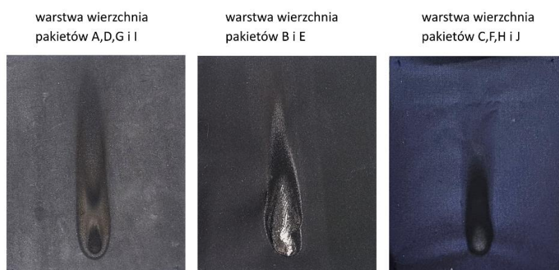
Rysunek 1. Zdjęcia przykładowych próbek materiałów wierzchnich pakietów materiałowych po wykonaniu badania odporności na ograniczone rozprzestrzenianie się płomienia.
